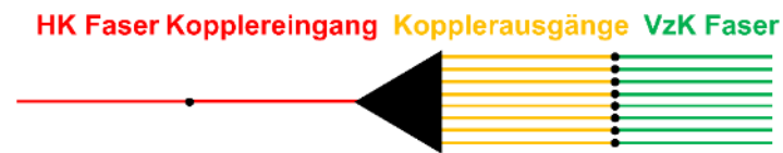
Abb. 32 Schaltbild HK über Koppler zum VzK
